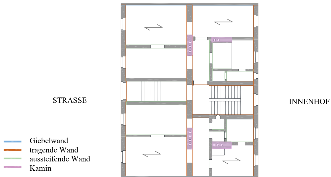
Abbildung 3-41: Wände und Kamine am Beispiel eines Gründerzeithauses
