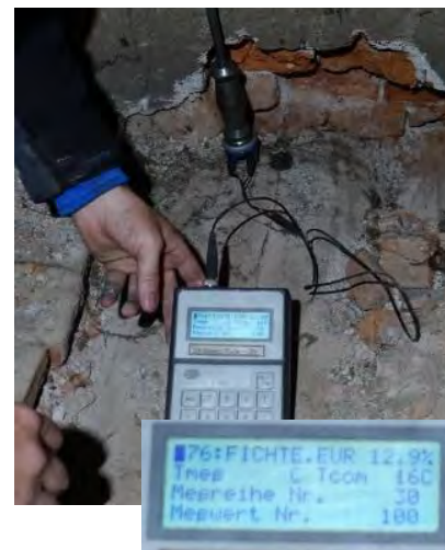
Abbildung 4-17: Feuchtigkeitsmessungen mit GANN Hydromette 4050 im freigelegten Dippelbaumbereich; links: Messwerte; rechts: GANN Hydromette bei Messung M1
