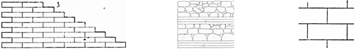
Abbildung 4-17: Mauerwerk (links: Ziegelmauerwerk; mittig: Mischmauerwerk; rechts: Quadermauerwerk) [30]
