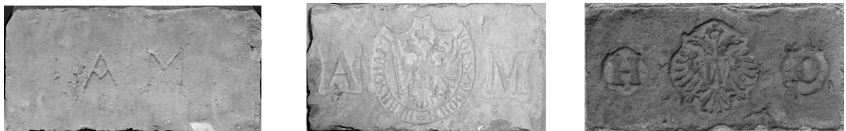
Abbildung 4-18: Ziegel von österreichischen Ziegelhersteller im 19. Jahrhundert (links und mittig: Hersteller Alois Miesbach; rechts: Hersteller Heinrich Drasche und Wienerberger) [33]
