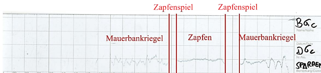
Abbildung 4-35: BGc Bohrwiderstandsabmessung durch die Verbindung Mauerbankriegel und Sparre
